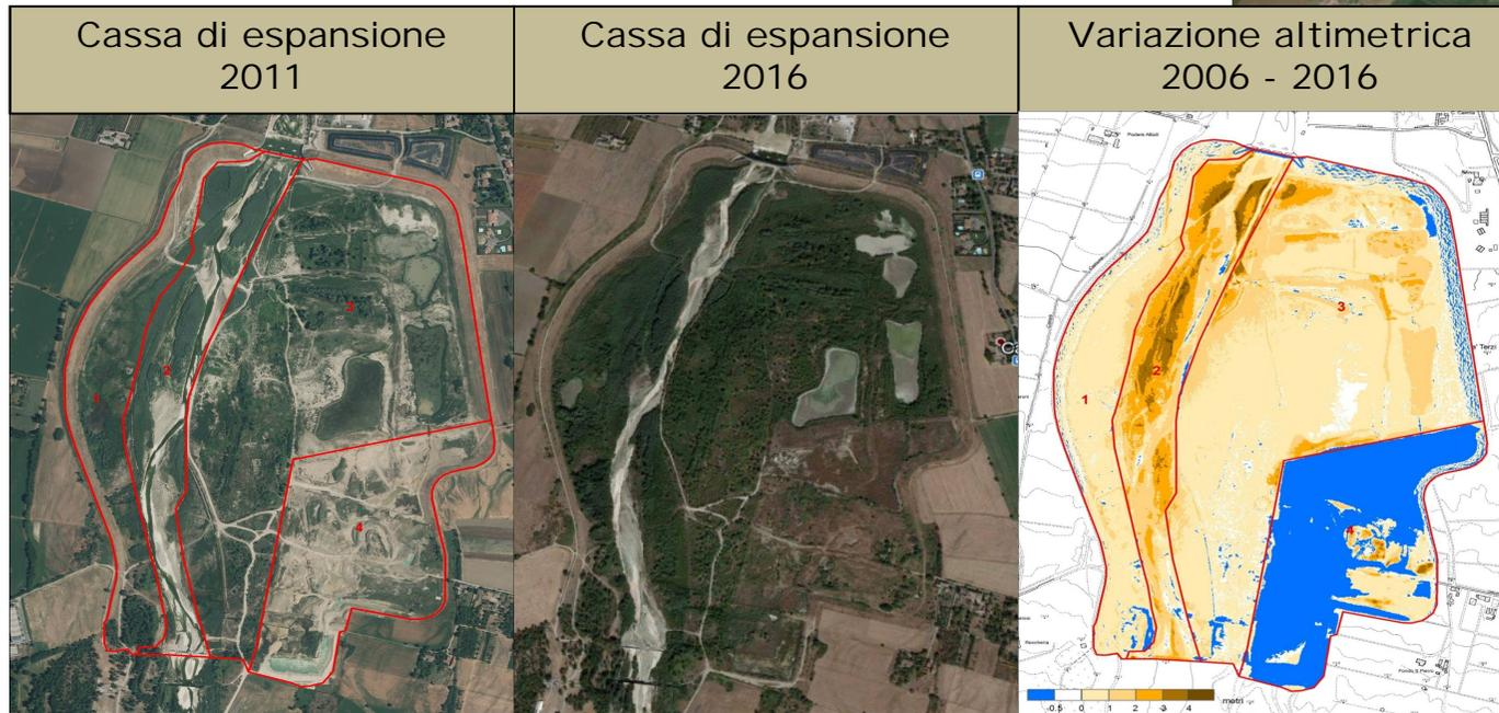
Confronto dei risultati di stima della portata solida con il volume complessivo accumulato in cassa valutato dalle rilievi **lidar** a disposizione
